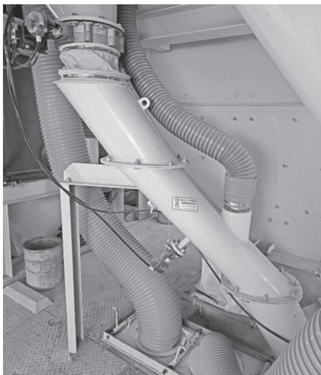
混和材貯蔵ビンに抜き取り可能な設備を導入
